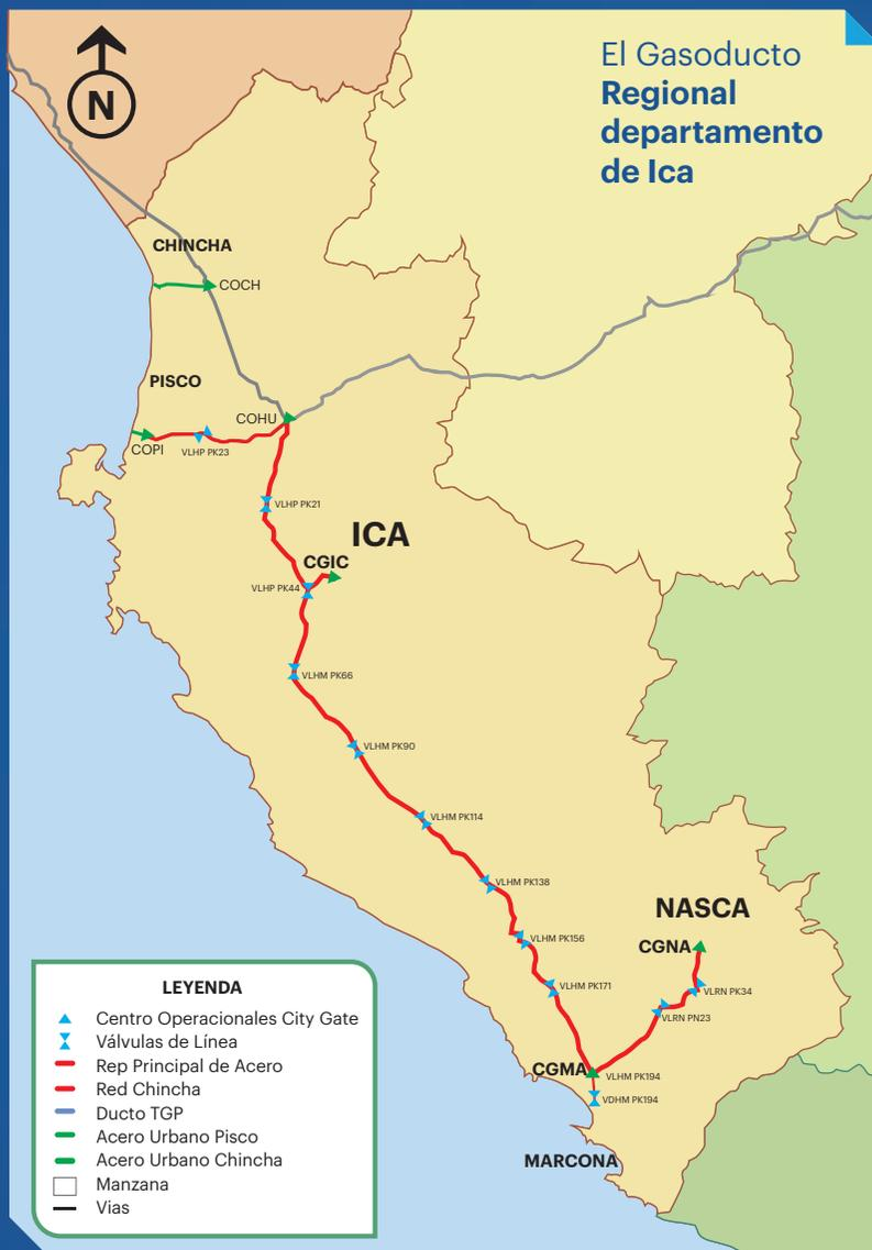
Manteniendo sus altos estándares en seguridad, se instalan válvulas de seccionamiento a lo largo de las redes con longitudes mayores a 24 km. En caso de fugas u otras emergencias, las válvulas bloquearán automáticamente las secciones del gasoducto en donde haya ocurrido el incidente.
